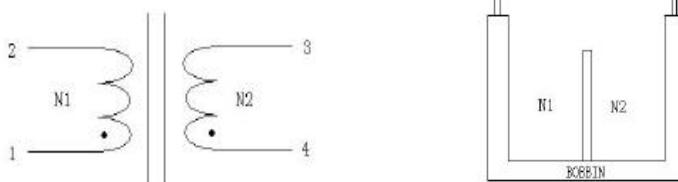
**绕线结构表 Winding Structure Diagram**
