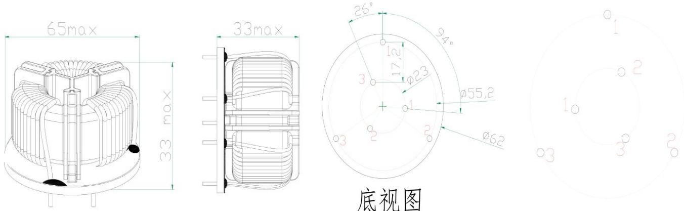
**1.2 (SCHEMATIC) 线圈联线图:**
