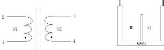
**绕线结构表 Winding Structure Diagram**
